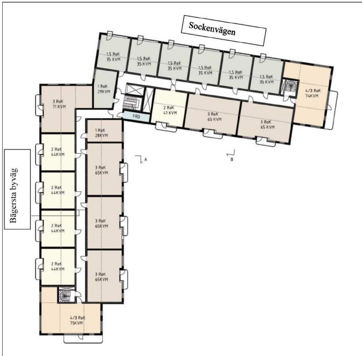
Bild 3 visar typplan för bostäder från plan 11 och uppåt
