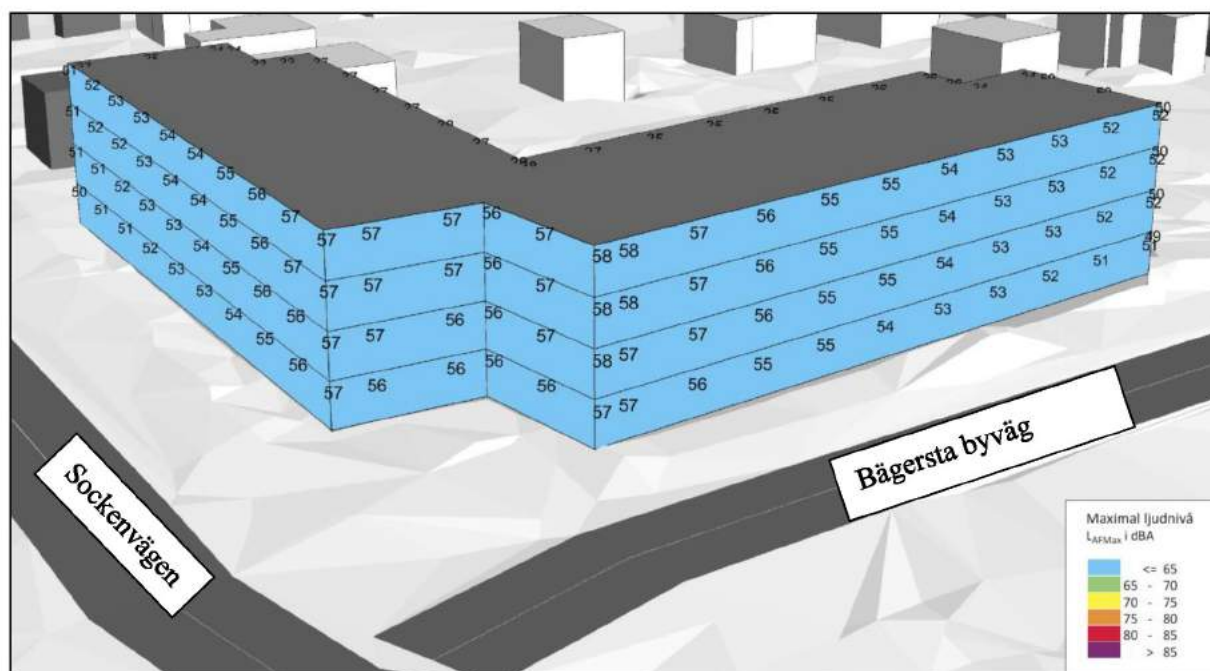
Bild 10 visar prognos för år 2040 för maximal ljudnivå på fasad mot Sockenvägen och Bägersta byväg för spårbunden trafik.
